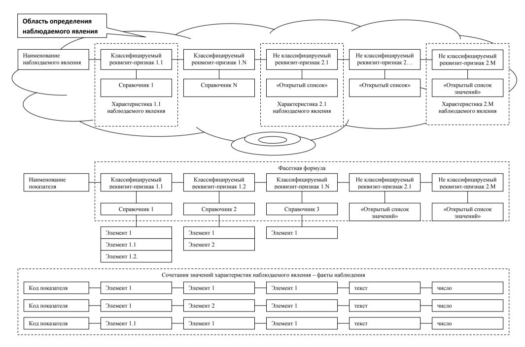
Справочники информационного фонда КПБС предназначены для типизации и регистрации уникальных допустимых значений КРП. Один и тот же справочник может быть связан сразу с несколькими КРП. Использование справочников для кодирования информации облегчает ее подготовку и обработку.
